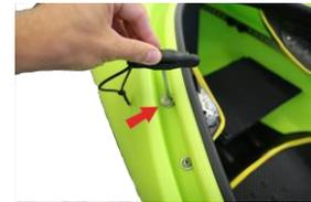
Um die Stützen zu versetzen greifen Sie zuerst mit der Hand zwischen Schaumpolster und Stütze und halten die Mutter fest. Anschließend lösen Sie die Schraube von außen komplett. Dann versetzen Sie die Mutter an die gewünschte Stelle in der Stütze, klicken die Stütze wieder auf das Distanzstück, so dass die Mutter genau unterhalb der Schraube sitzt und ziehen sie fest. Den Innensechskant-Schlüssel nun wieder auf der Rückseite des Rückengurts fixieren.
