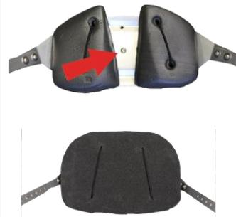
Legen Sie die Prallplatte wieder ins Boot und fixieren Sie sie mit den Rändelmuttern. Dann bauen Sie den Keil durch Drücken unten und Ziehen oben wieder ein.
