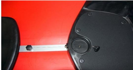
**Schritt 3:** Rändelschraube durch das Loch stecken und anschrauben, aber noch nicht komplett fest ziehen.
