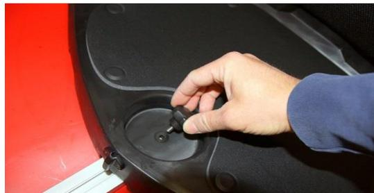
**Schritt 4:** Sitz in die gewünschte Position schieben und anschließend die Rändelschraube fest anziehen.
