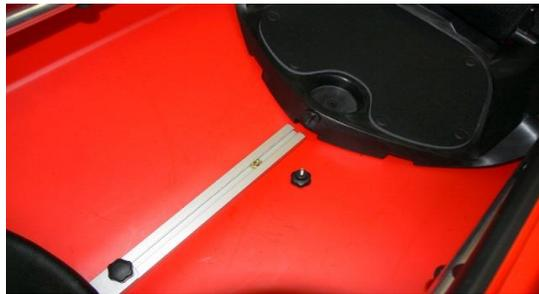
**Schritt 2:** Schiene mittig in die dafür vorgesehene Aussparung unter den Sitz schieben, bis man von oben durch das Loch die Mutter erkennt und diese genau mittig unter dem Loch liegt.
